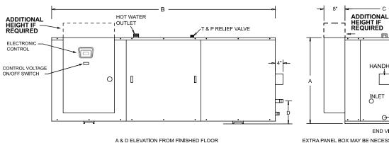
EXTRA PANEL BOX MAY BE NECESSARY FOR INPUTS HIGHER THAN 72KW. CONSULT FACTORY
